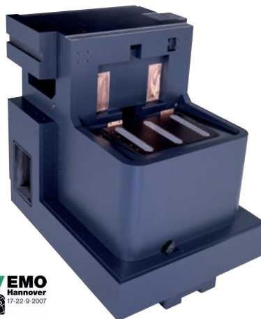
Mineralgussgestell der FORM 2000/3000 als Systemlösung komplett spanlos hergestellt
