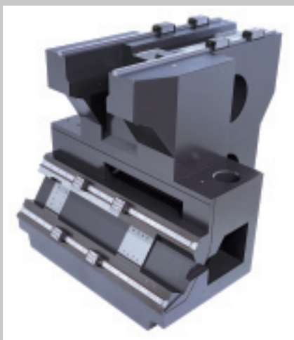
Mineralgussgestell der MIKRON HPM600HD als Systemlösung komplett spanlos hergestellt.
