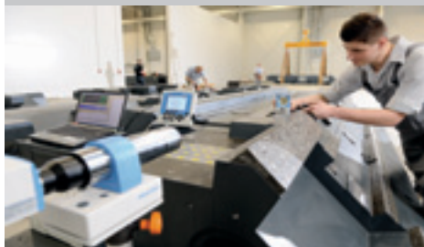
Autokollimatormessung eines Mineralgussbettes
