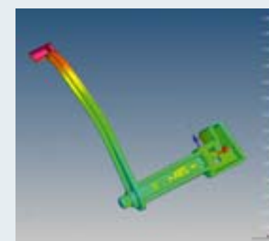
Maßabweichungen von den Sollwerten kennzeichnet der Metrotom 800 durch Farben, hier bei einem ABS-Bauteil. Besonders hilfreich: Die Abweichungen lassen sich ausmessen. Möglich wird dies durch Überlagern des CAD-Modells
