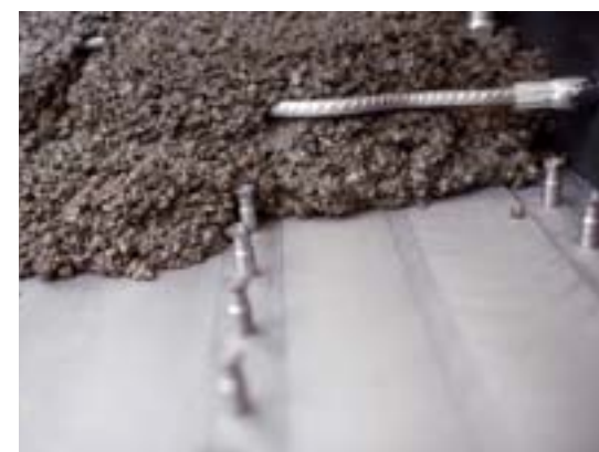
Polymerbeton in der Verarbeitung: Medienz- und abführungen können direkt in den Mineralguss-Rohling eingegossen werden
