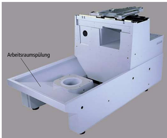
Bild 1: Integrierte Arbeitsraumspülung im Maschinenbett eines Bearbeitungszentrums. Das Spülmedium wird von einem zentralen Eingang an die Austrittsstellen geleitet.
