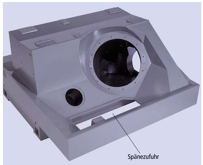
Bild 2: Die Zuführung zum Spänekasten lässt sich direkt in die Gestellstruktur integrieren. So können bei intensivem Spänebeschuss partiell Verschleißbleche eingegossen werden.
