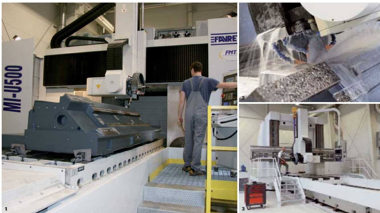
1 Vor dem Schleifen auf der Favretto-Präzisionsschleifmaschine werden die Maschinenbetten genau eingemessen. 2 Maschinenbetten werden bis auf das \mu genau geschliffen. 3 Auf der NC-Präzisionsschleifmaschine von WMW haben Werkstücke bis zu sieben Metern Länge und einem Maximalgewicht bis zu 25 Tonnen Platz.
